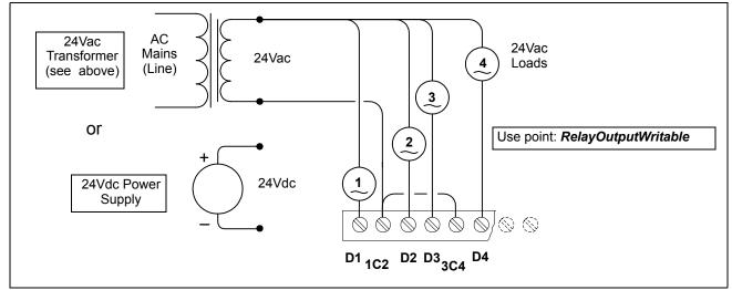
Fig. 12. Relay output wiring diagram.
