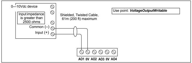
Fig. 13. Analog output wiring diagram.
