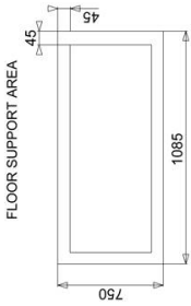
SUPERFICIE PER APPOGGIO PLENUM PLENUM SUPPORT AREA
